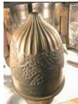
Les deux sections du moule ci-dessus seraient l'image inverse puisque le fabricant de moules aurait dû creuser dans le moule
